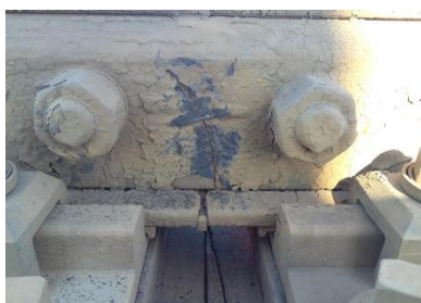
Beelden van een scheurvorming in een ES-las (links) en een horizontale scheurvorming puntstuknaald (rechts) uit het huidige videoschouwsysteem.
