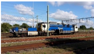
De voertuigen waarmee wissels en spoor worden gemeten.
