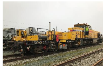
De voertuigen waarmee wissels en spoor worden gemeten.
