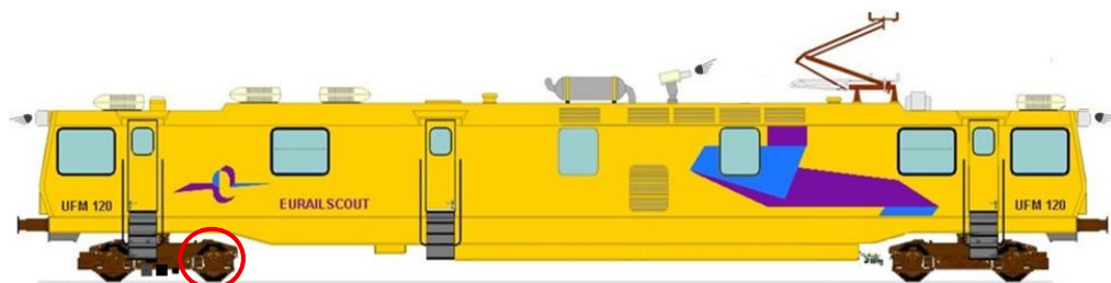
Figuur 1. Positie meetsysteem Spoorgeometrie korte golf op UFM120
