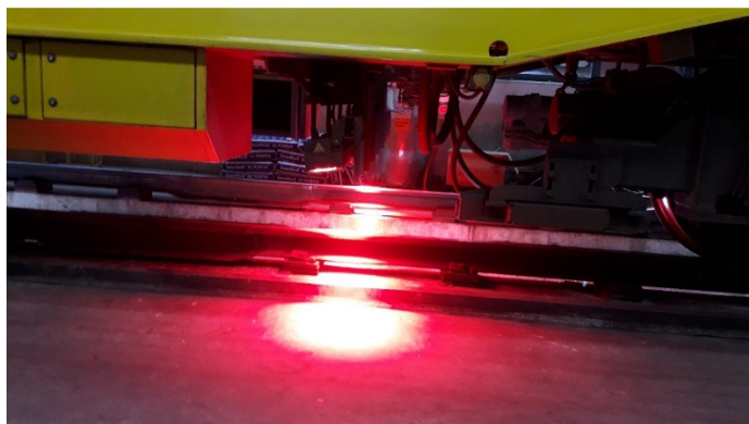
Figuur 2. Meetsysteem gemonteerd onder de UFM120.
