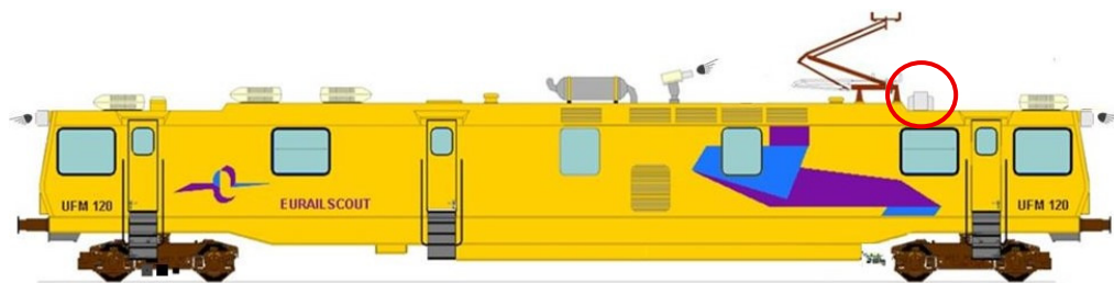
Figuur 1. Positie meetsysteem Rijdraadligging statisch / dynamisch op UFM120
